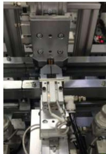
气动机械夹实现了对电阻焊点的拉力全检，做到了**虚焊**全检出
